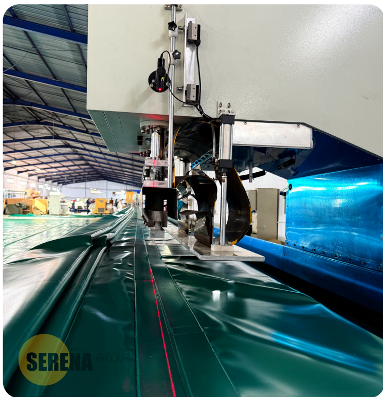
Visokofrekvenčni varilni stroj na 30 metrov dolgi mizi
